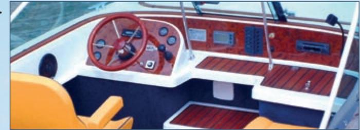
Bordcomputer und Batteriestatusanzeige informieren genau über Stromverbrauch und Vorrat. So bleibt man nie liegen.
